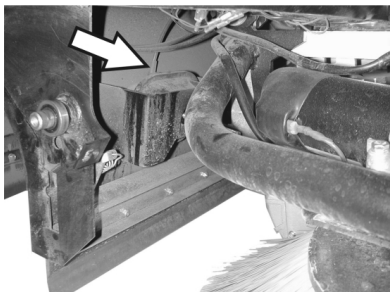
Slangetilkobling for undertrykksslange for senking av sidebørster
