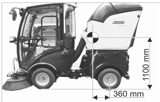
Poziția centrului de greutate la aparat complet încărcat.
