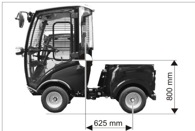
Poziția centrului de greutate fără accesorii montate.
